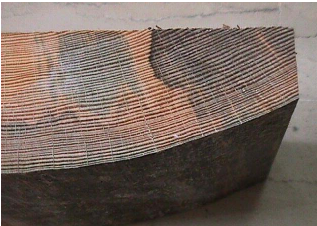
Εμφάνιση κυάνωσης σε εγκάρσια τομή πεύκου
