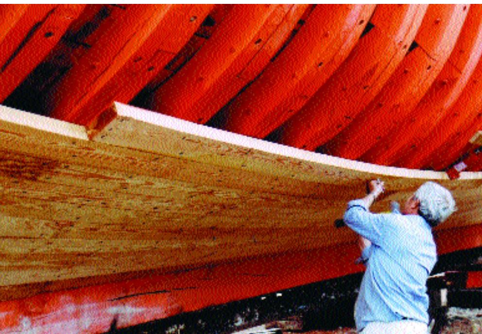
Κάρφωμα του πετσώματος στο ιστιοφόρο σκάφος "Κίρκη"
