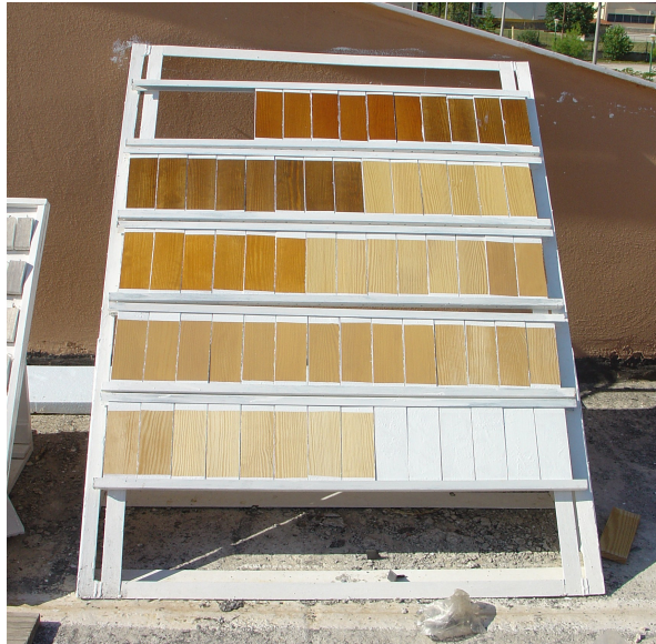
Εικόνα 2: Βάση στήριξης δοκιμίων για φυσική γήρανση (έναρξη γήρανσης)
