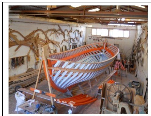
Παραδοσιακό τρεχαντήρι κατά τα στάδια της κατασκευής του (2010, ξυλοναυπηγείο Αθανασίου Βλάμη, Σύρος) (φωτ. Χ. Δαφνά)
