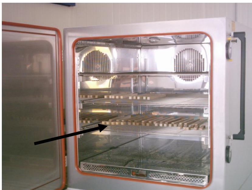
Κλιματισμός δοκιμίων ξύλου πριν τις μετρήσεις (φωτ. αρχείου).
