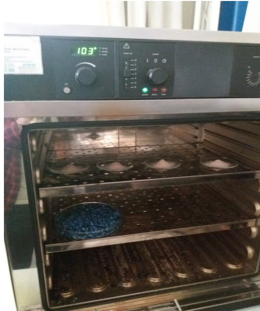
Εικόνα 2. Ξήρανση κονιορτοποιημένου υλικού σε θερμοκρασίες 103\pm 2 C για 24h.
