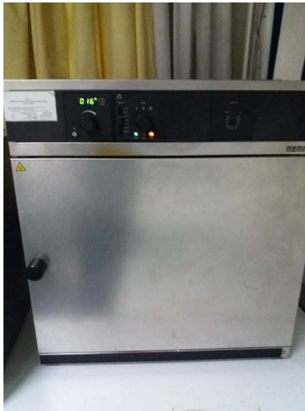
Εικόνα 1. Ξήρανση υλικού σε θερμοκρασίες 103 \pm 2 C για 24h.
