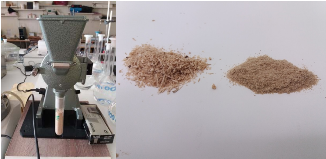
Εικόνα 1. αριστερά: Μύλος τύπου WILEY, δεξιά: πριονίδι και κονιορτοποιημένο υλικό μετά την ξήρανση.
