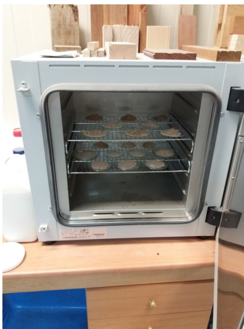
Εικόνα 2. Ξήρανση υλικών σε πυριατήριο σε θερμοκρασίες 103 \pm 2 C για 24h.
