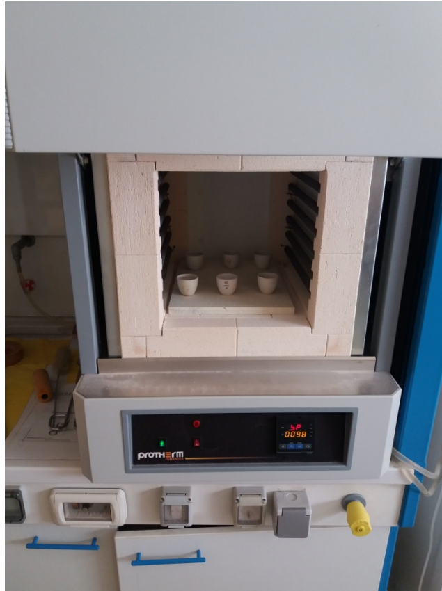
Εικόνα 4. Εργαστηριακός κλίβανος αποτέφρωσης.
