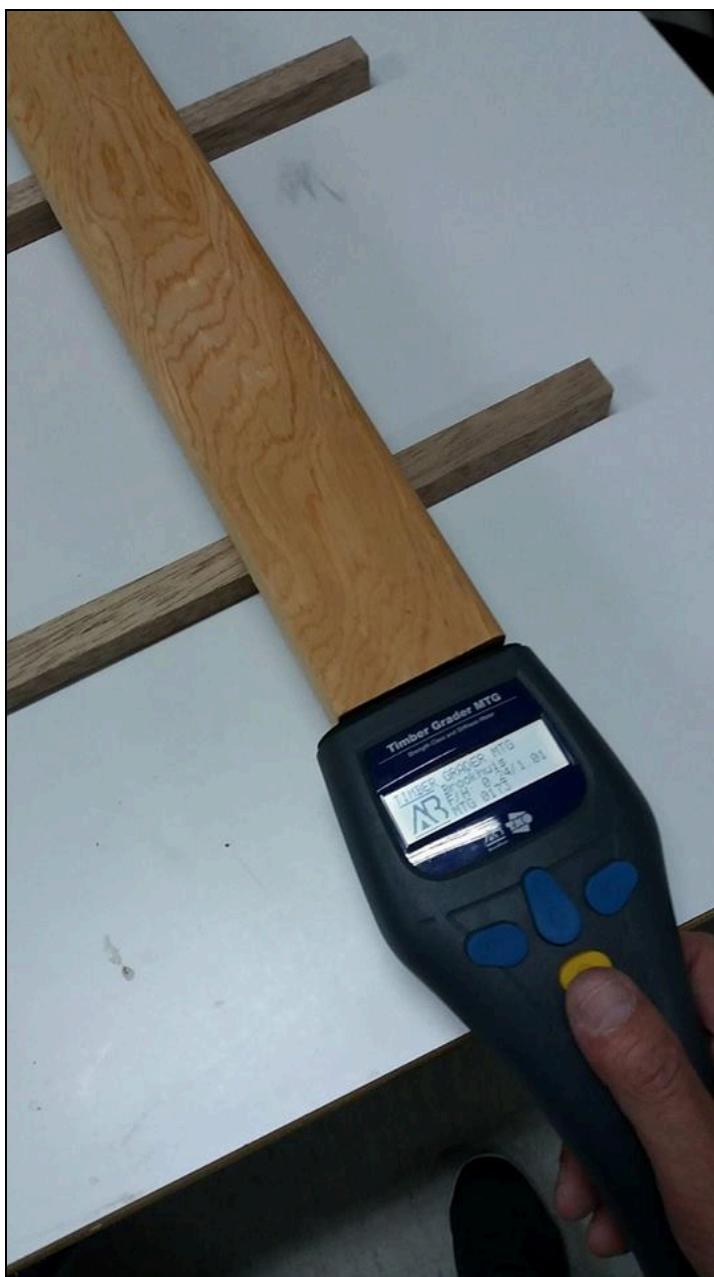
Εικ. 6. Άποψη από τις μετρήσεις με Timber Grader® που έγιναν στη μελέτη αυτή (ref. http://www.brookhuis.com/timber-grader-mtg.html )
