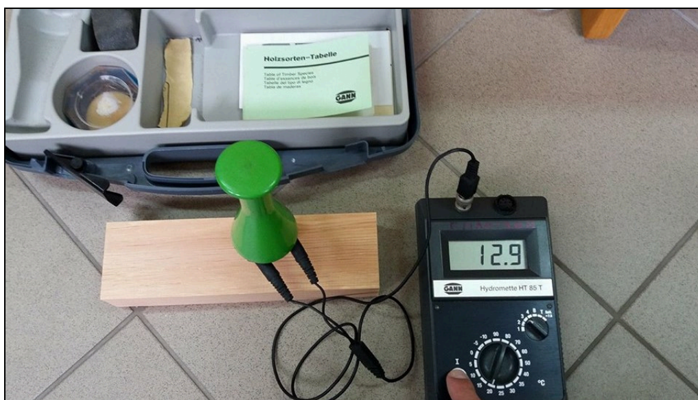
Εικ. 4 Μετρήσεις περιεχόμενης υγρασίας με σύγχρονο υγρόμετρο Gann.
