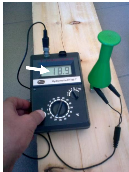
Εικ. 4. Μετρήσεις υγρασίας του πριστού με σύγχρονο υγρόμετρο Gann
