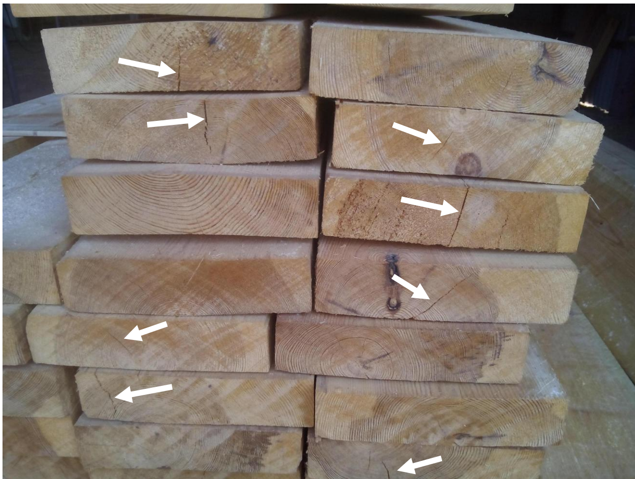
Εικ. 1. Ντάνα ξυλείας πεύκου (βλ. έντονες ραγαδώσεις στα σόκορα)
