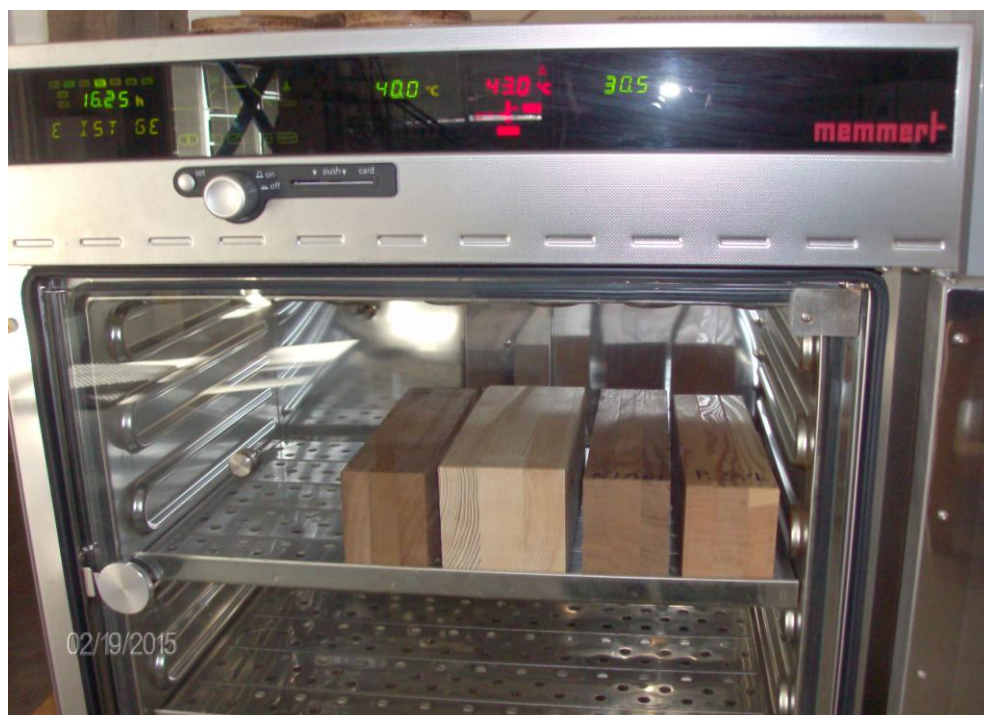
Εικ. 9. Ο θάλαμος κλιματισμού σε ξηρές συνθήκες (40°C & Σ.Υ. 30%)
