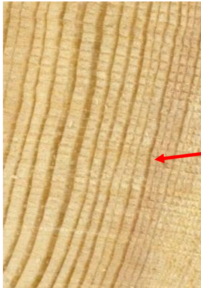
Εικ. 6. Εγκάρσια τομή ξύλου: πολύ στενοί αυξητικοί δακτύλιοι, ξύλο από φυσικό δασικό οικοσύστημα - όχι φυτείες! (ηλικίας >60 ετών), έντονο εγκάρδιο πεύκου, πολλοί ρητινοφόροι αγωγοί και ξυλεία υγιής με στενούς αυξητικούς δακτυλίους .
