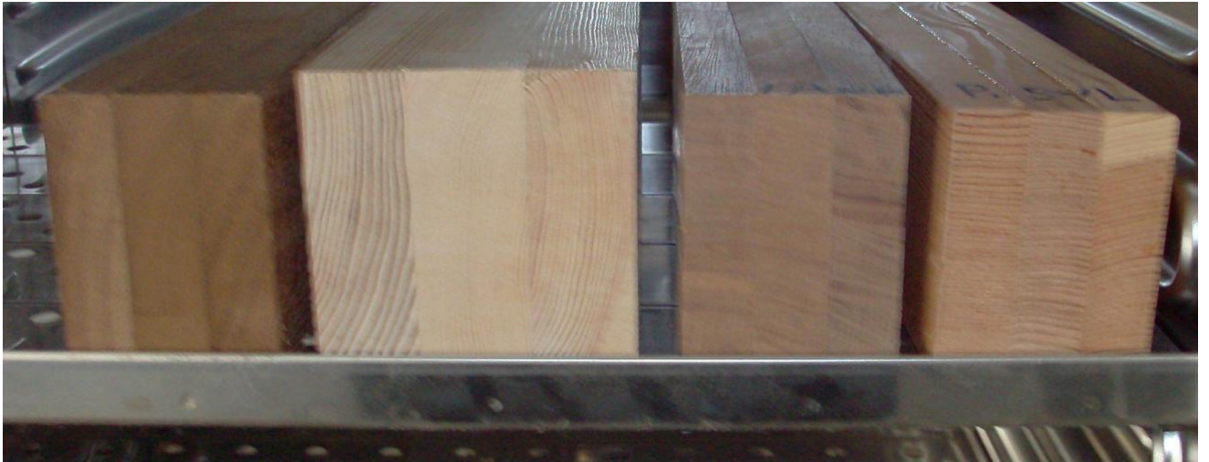
Εικ. 10. Συγκριτική δοκιμασία προϊόντος σε σχέση με: Iroko, R. Meranti & Belmadur
