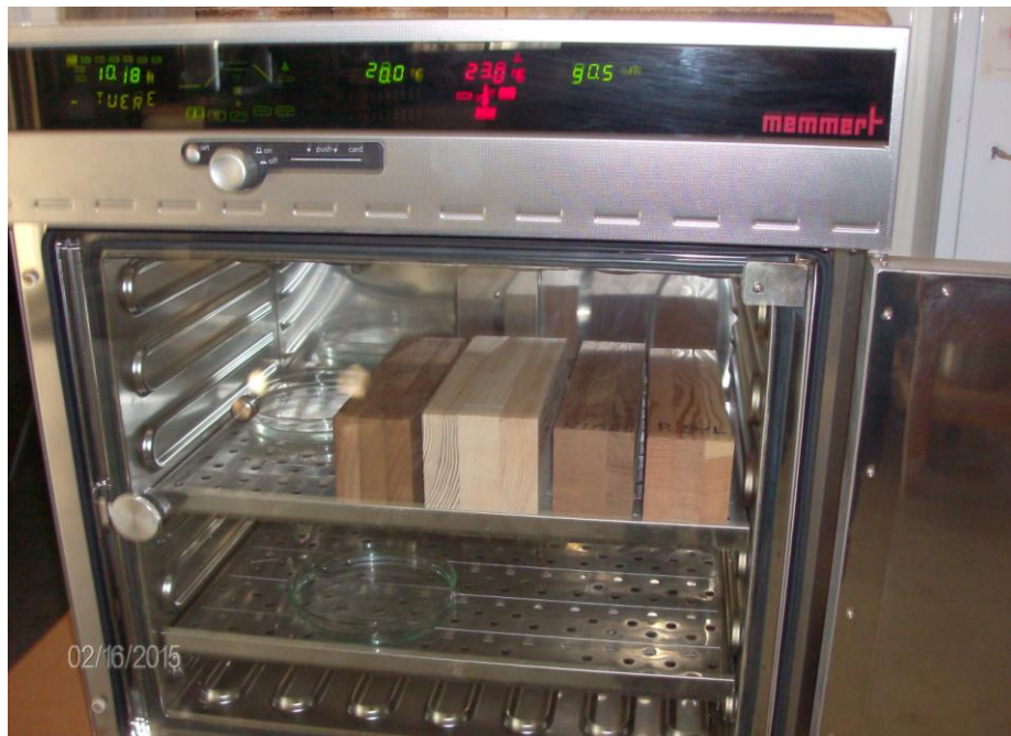
Εικ. 8. Ο θάλαμος κλιματισμού σε υγρές συνθήκες (20°C & Σ.Υ. 90%)
