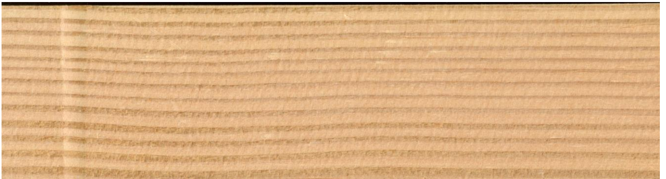
Εικ. 9. «Καθαρή» ακτινική τομή (ισόβενια νερά ξύλου): πολύ υψηλή ευθυΐνια, μεγάλη ομοιογένεια και καθόλου σφάλματα δομής ή ασυνέχειες ή μεταχρωματισμοί.
