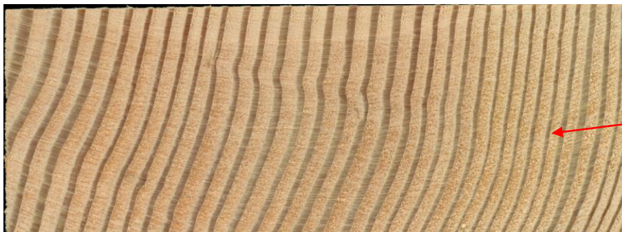
Εικ. 7. Εγκάρσια τομή πριστού («2»): πολύ στενοί αυξητικοί δακτύλιοι, ξύλο από φυσικό δασικό οικοσύστημα - όχι φυτείες! (ηλικίας >50 ετών), έντονο εγκάρδιο
