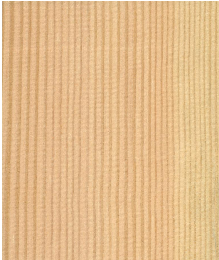
Εικ. 6. Χαρακτηριστική εμφάνιση της ακτινικής τομής των πριστών που συλλέχθηκαν (παντελής απουσία σφαλμάτων δομής, καθόλου ρόζοι, παντελής έλλειψη ραγάδων!)
