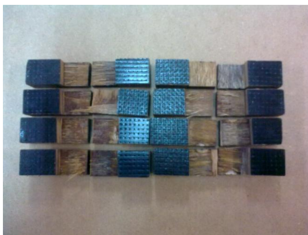
Εικ. 17. Αποκολλημένα φύλλα στα οποία φαίνονται υπολείμματα ρητίνης φαινόλης (PF).
