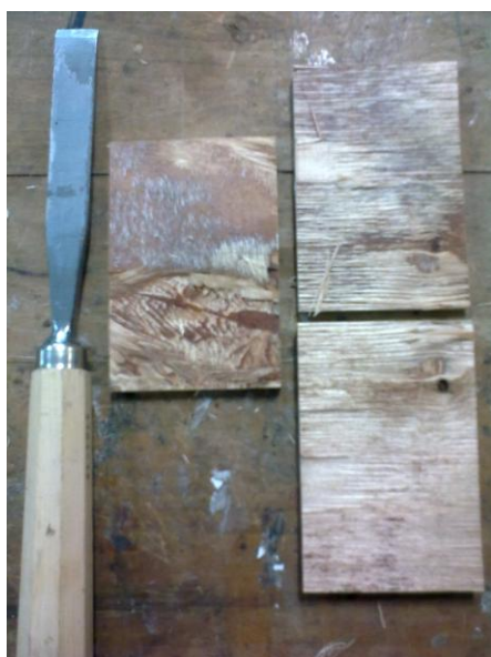
Εικ. 17. Αποκολλημένα φύλλα στα οποία φαίνονται υπολείμματα ρητίνης φαινόλης (PF).
