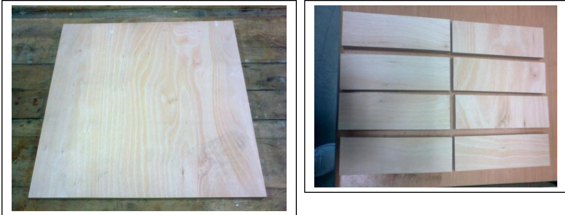
Εικ. 1-2. Το δείγμα Κ/Π κατά την παραλαβή του και τα 8 δοκίμια για τη δοκιμή JIS-A-1460.
