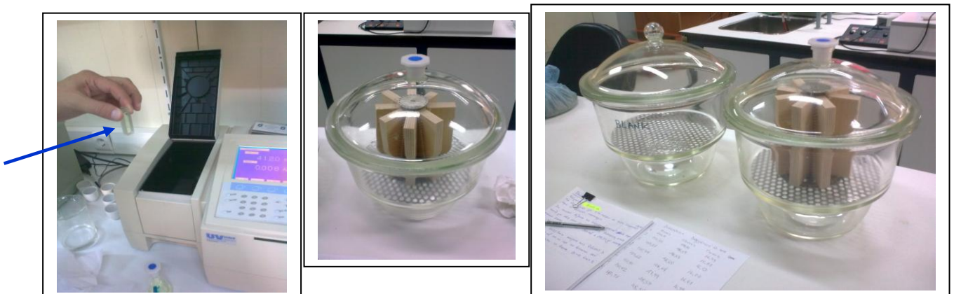
Εικ. 3-4-5. Desiccator test: Δοκίμες εκπομπής αέριας φορμαλδεΐδης (JIS-A-1460)
