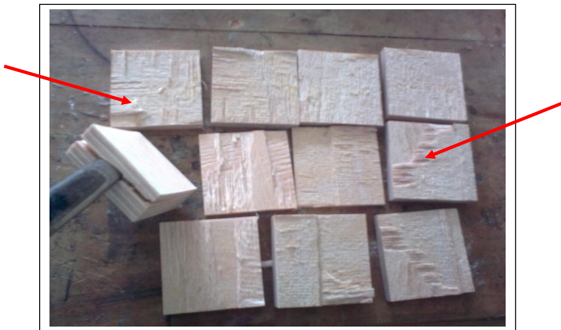
Εικ. 13. Μακροσκοπική εμφάνιση των αποκολλημένων δοκιμών Κ/Π (μέθ. σκαρπέλου)
