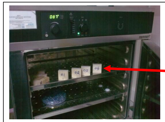
Εικ. 6-7. Μικρά δοκίμια από το Κ/Π για μέτρηση της υγρασίας σε ειδικό πυριατήριο (103°C)
