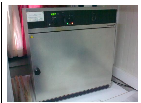
Εικ. 6-7. Μικρά δοκίμια από το Κ/Π για μέτρηση της υγρασίας σε ειδικό πυριατήριο (103°C)
