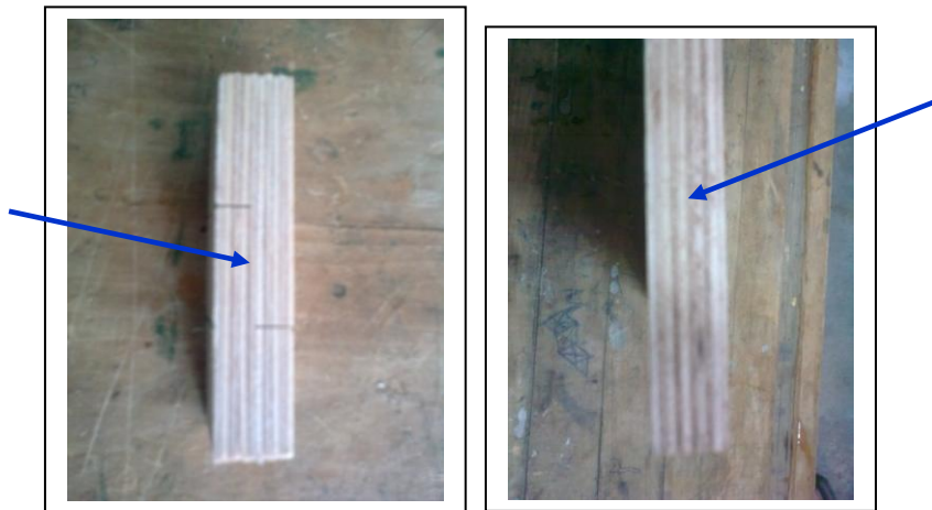
Εικ. 4-5. Εμφάνιση των «κλειστών σόκορων» του δείγματος Κ/Π.
