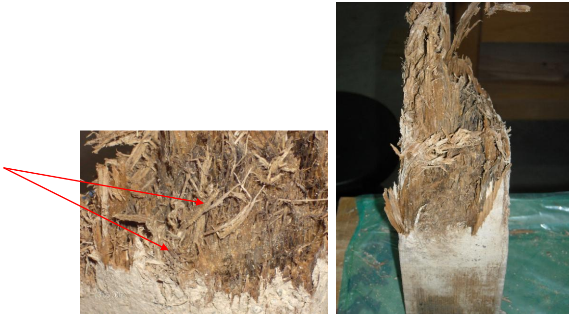
Εικ. 12-13. Ξύλο ερυθρελάτης ήδη σε προχωρημένη σήψη και μερική αποϊνώση
