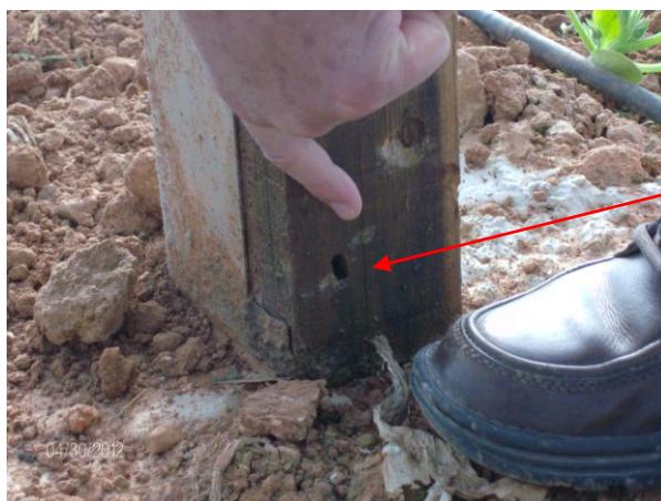
Εικ. 20. Ξυλεία ορθοστάτη από ερυθρελάτη, σε μεγάλη οπή προσβολής
