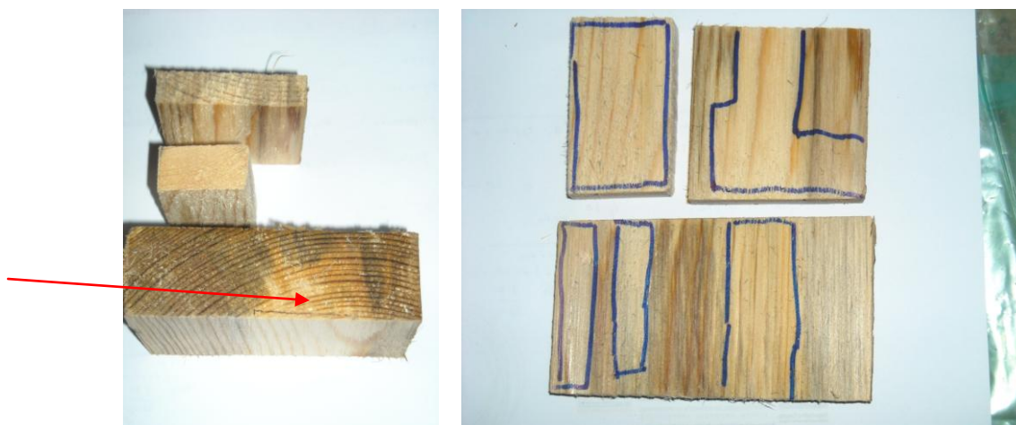
Εικ. 14-15. Κατά θέσεις, πλημμελής εμποτισμός σε δείγμα ξυλείας ερυθρελάτης
