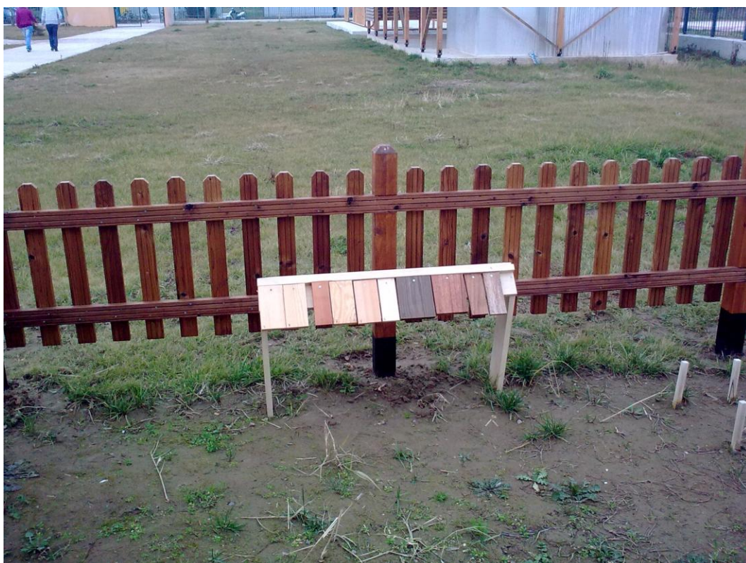
Εικ. 1: Τοποθέτηση των δειγμάτων, υπό γωνία ~60 μοιρών, σε έκθεση στις καιρικές συνθήκες αλλά με καλυμμένα τα ως άνω σόκορα των δοκιμίων με προστατευτικό πηχάκι (ημερ/νία: 20-Ιαν-2011).
