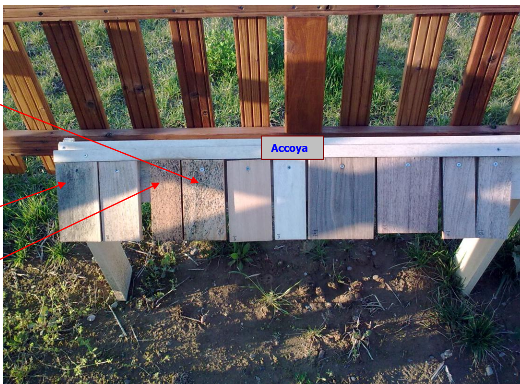
Εικ. 2: Εξωτερική εμφάνιση των δοκιμών ξύλου την 24-Μαρτ-2011. Με βέλη φαίνονται δοκίμια που έχουν υποστεί έντονη κυάνωση (σκουρόχρωμους μεταχρωματισμούς) χωρίς όμως σημάδια σήψης.
