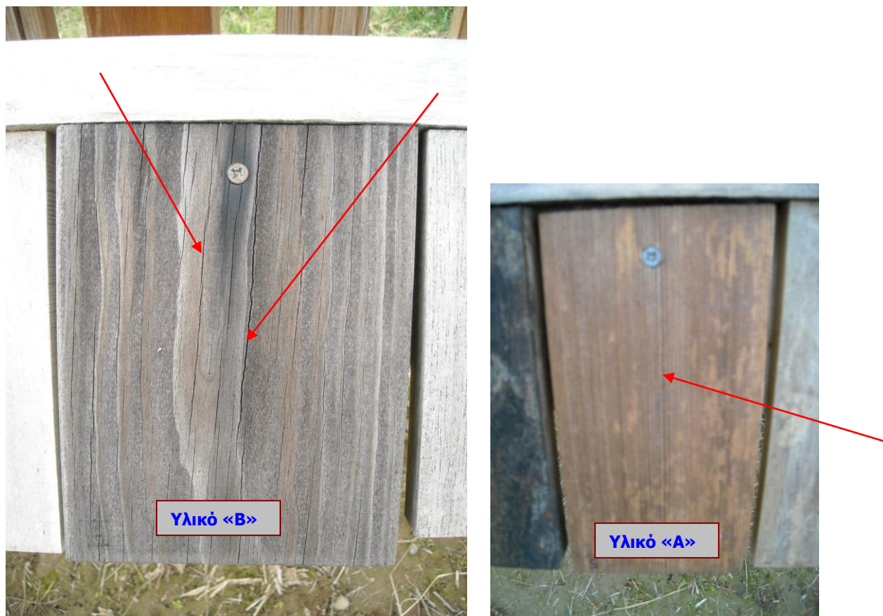
Εικ. 7: Εξωτερική εμφάνιση του «Α» και «Β» υλικού, την 15-Δεκ.-2011 (Σημ.: το νέο υλικό «Β» έχει πολλές και εκτεταμένες ραγαδώσεις και σχισίματα στα σόκορα)
