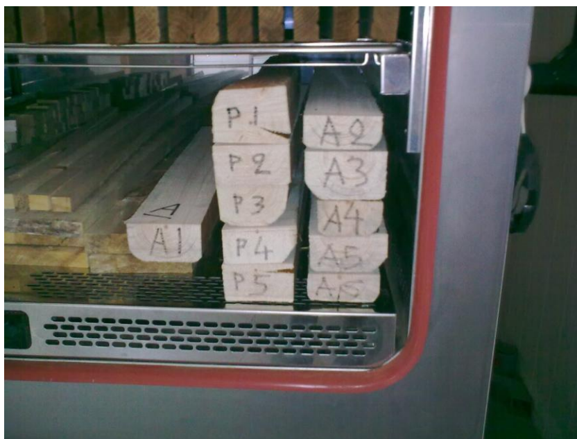
Εικόνα 1. Δοκίμια από τις 2 παρτίδες των κομμένων ήδη πελεκητών ερυθρελάτης (πριν τις δοκιμές), όπως κλιματίζονται σε κανονικές συνθήκες (θερμοκρασία: 20°C, σχετική υγρασία του αέρα: 65%).
