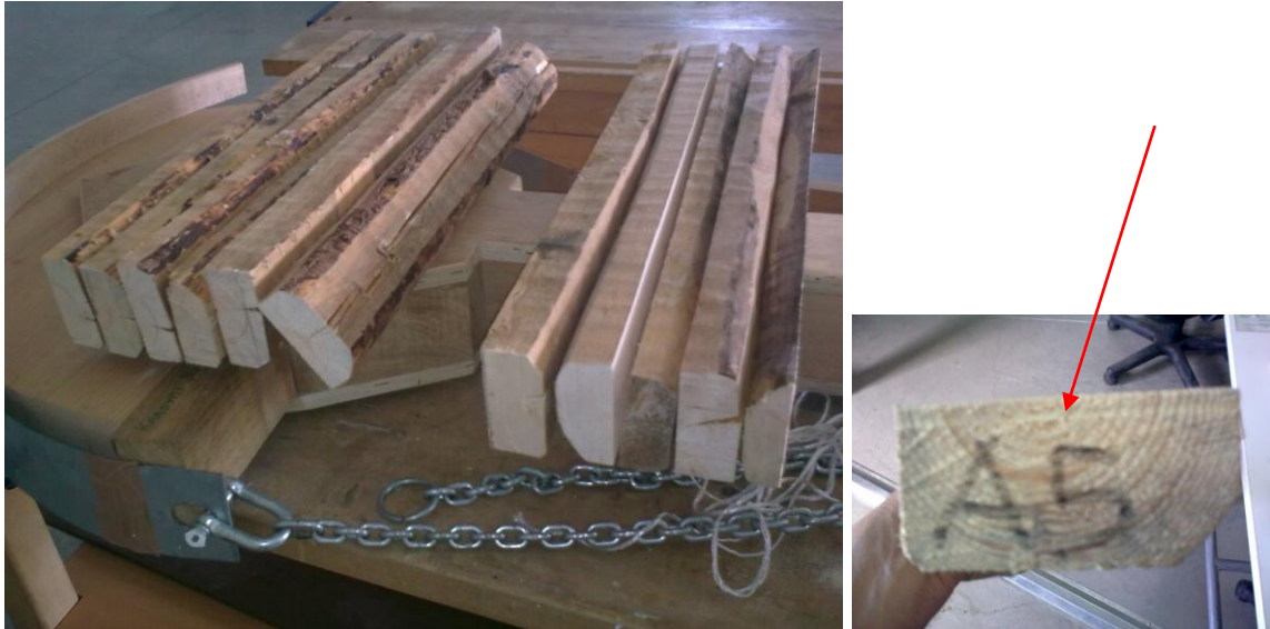
Εικόνα 2. Δοκίμια κομμένα (αριστερά) και από τις 2 παρτίδες πελεκητών (φαίνεται δεξιά το πώς κόπηκαν, δηλ. ~πάνω στη γραμμή εντεριώνης)
