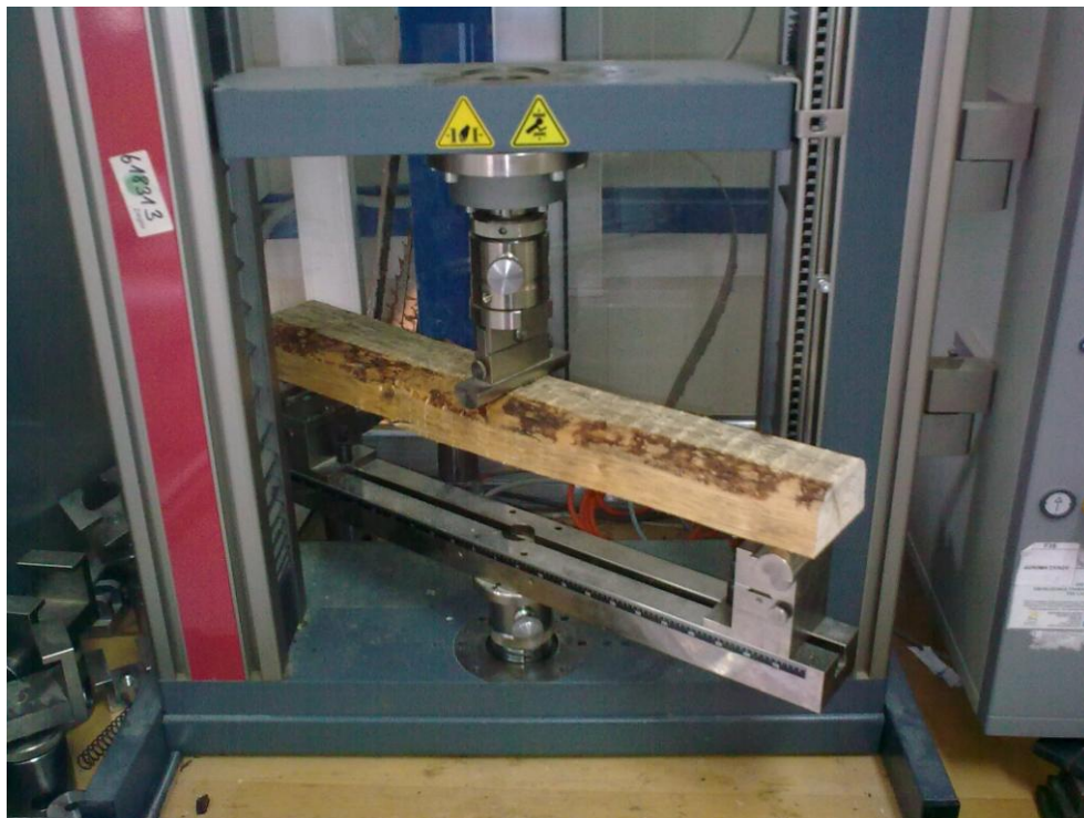
Εικόνα 3. Τυχαίο δείγμα την ώρα της δοκιμής του σε θραύση (ΜΘ & ΜΕ) σε συσκευή μηχανικών αντοχών τύπου Zwick-Roell 2020 testing machine (Software testXpert V10.11) του Τμήματος Σ.Τ.Ξ.Ε. του Τ.Ε.Ι. Λάρισας
