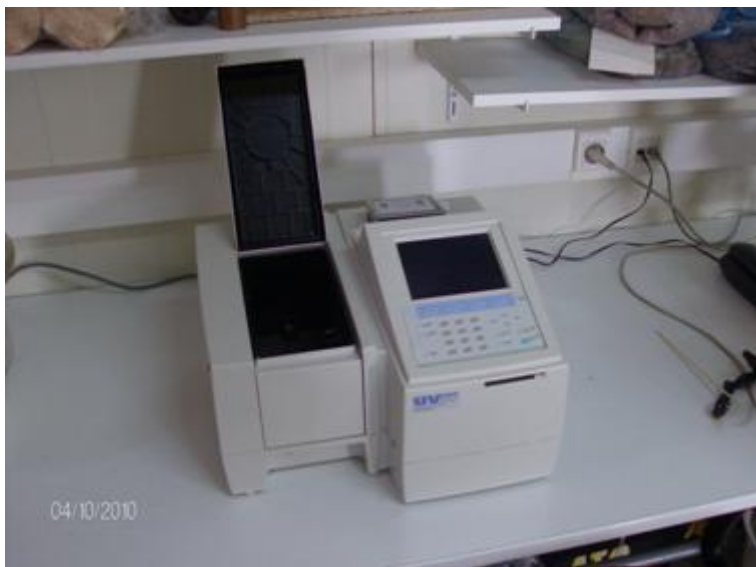
Εικ. 3. Σύγχρονη συσκευή φασματοφωτόμετρου (Ιαπωνικού τύπου Shimadzu, spectrophotometer) στην οποία έγιναν οι φωτομετρικές αναλύσεις των δειγμάτων
