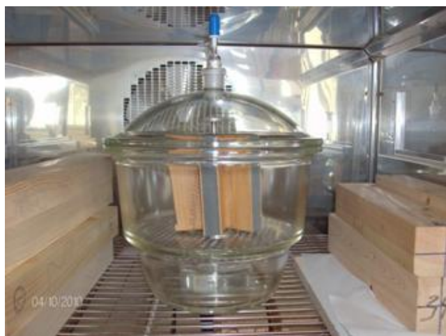
Εικ. 2. Τα δείγματα πλαστικού δαπέδου εντός του ειδικού Desiccator για παραμονή στον σύγχρονο θάλαμο κλιματισμού, σε θερμοκρασία δωματίου, 20/65 (για συνολικά 24 ώρες).
