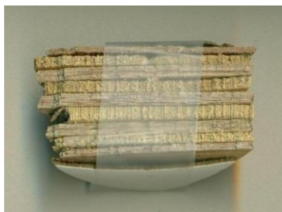
Εικόνα 3. Τα ήδη αποκολλημένα φύλλα του δείγματος κόντρα-πλακέ αριθ. 5.
