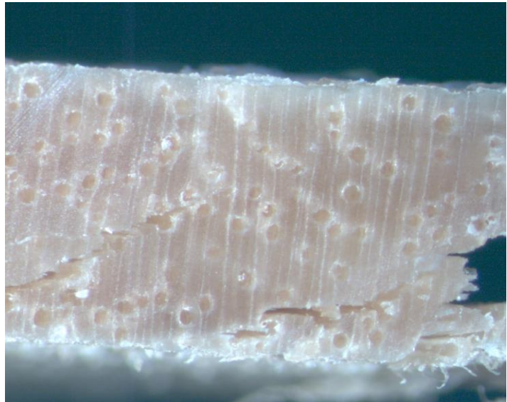
Εικόνα 7. Το 3 ο φύλλο του κόντρα-πλακέ (εσωτερικό) είναι Okoume .
