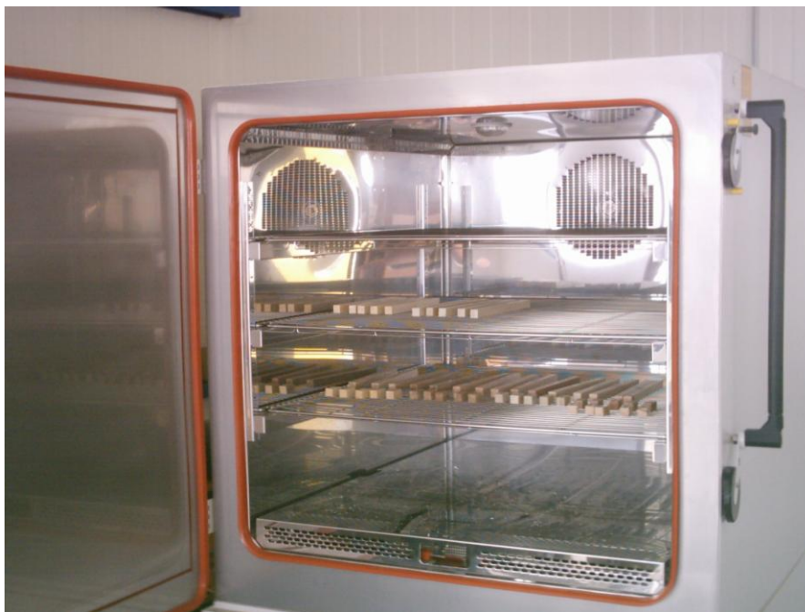
Θάλαμος κλιματισμού όπου έγινε ο κλιματισμός των δειγμάτων (φωτ. αρχείου)
