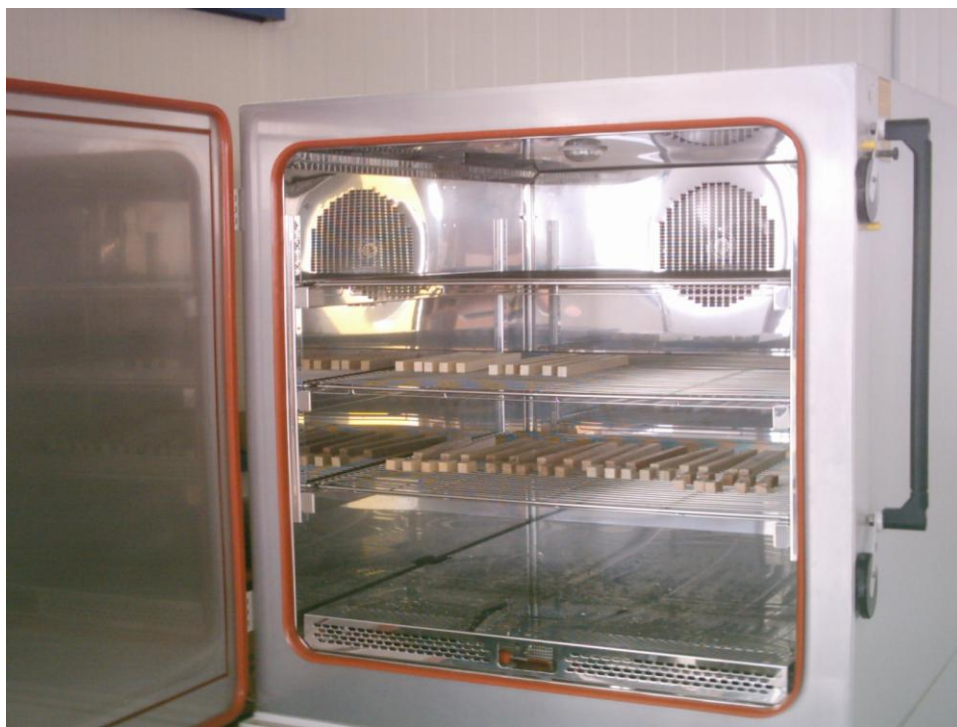
ΕΙΚ. 3 Κλιματισμός δοκιμίων πριν τη διεξαγωγή των δοκιμών.
