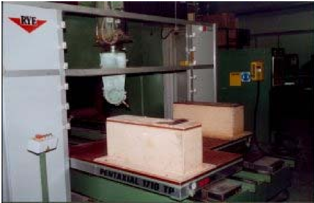
Εικ. 1.1. Εργαλειομηχανή πέντε αξόνων παλαιού τύπου.
