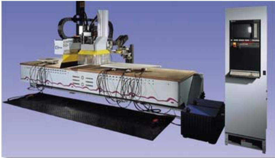
Εικ. 1.9 Το ειδικό ελαστικό πάτωμα ακινητοποιεί την εργαλειομηχανή με την άσκηση βάρους πάνω από 35 Kg. Στο βάθος διακρίνεται η πλαστική ποδιά γύρο από την κεφαλή.
