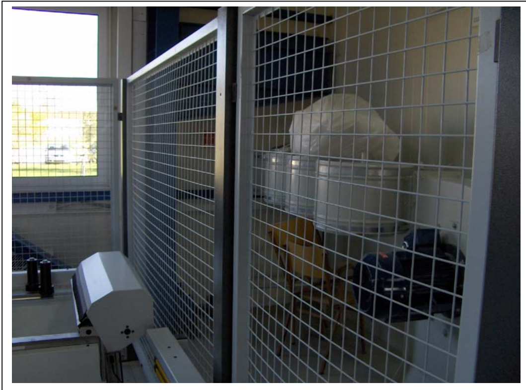
Εικ. 1.11 Το μεταλλικό πλέγμα που τοποθετείται γύρω από την μηχανή.
