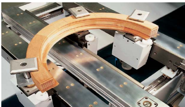
Εικ. 1.2 Μέθοδος συγκράτησης με μεταλλικές δαγκάνες, σε τράπεζα εργασίας με ράγες.
