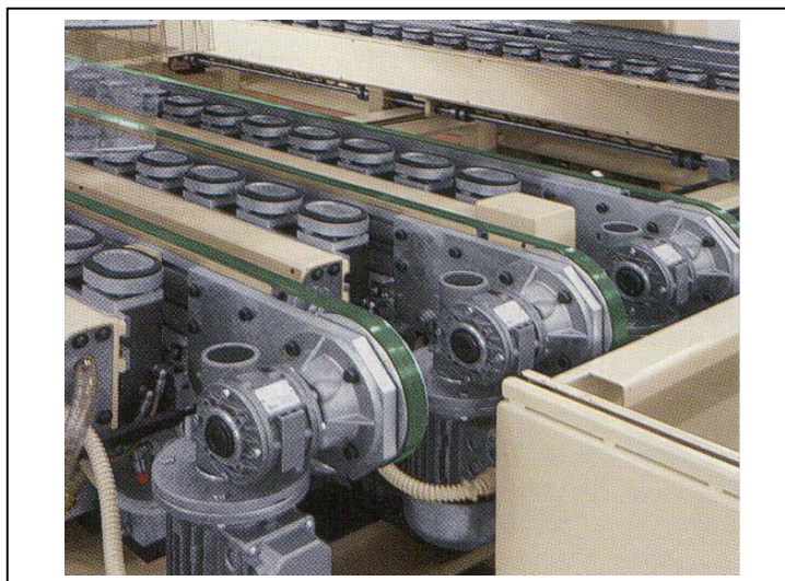
Εικ. 1.5 Τράπεζα με βεντούζες πάνω σε αλυσωτή τράπεζα.
