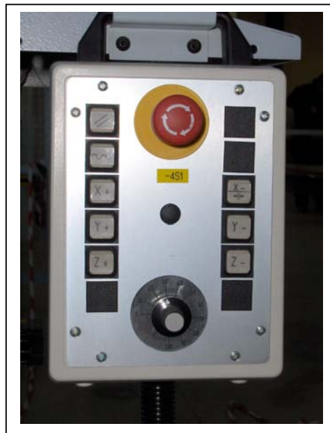
Εικ. 1.12 Το μανιτάρι (κουμπί κόκκινου χρώματος) όπως είναι στο χειριστήριο
