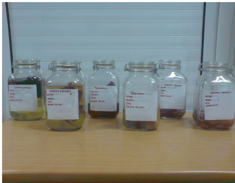
Εικόνα 20: Πείραμα διόγκωσης δειγμάτων σε νερό.
