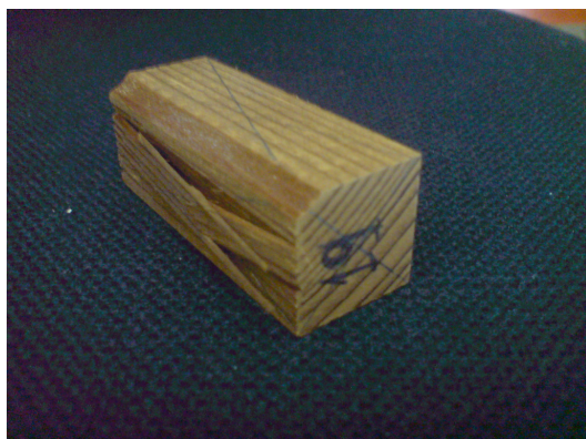
Εικόνα 27: Δείγμα ThermoWood: παρουσιάζει ευθραυστότητα στις ίνες του.
