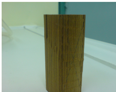
Εικόνα 28: Δείγμα ThermoWood: ολίσθαινει κατά 45°.
