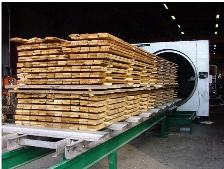
Εικόνα 16: Φόρτωση σανιδιών πεύκου σε θερμαινόμενη δεξαμενή.
