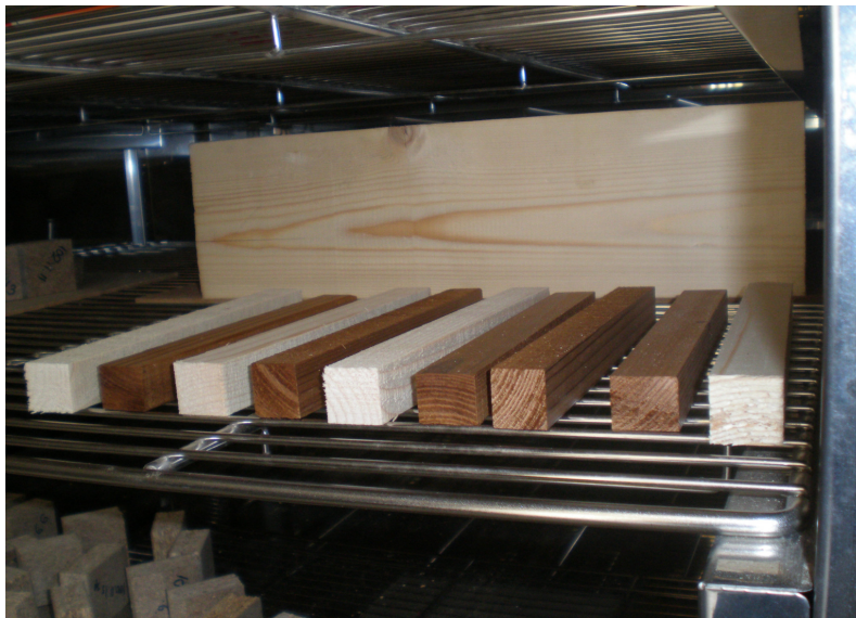
Εικόνα 23: Δείγματα ThermoWood και μη τροποποιημένη πεύκη, κλιματίζονται σε θάλαμο κλιματισμού σε κανονικές συνθήκες (20°C, 65% σχετική υγρασία)
