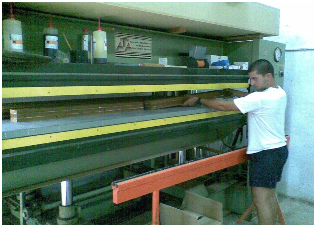
Εικ. 7 Τοποθέτηση των ξύλων στη πρέσα
