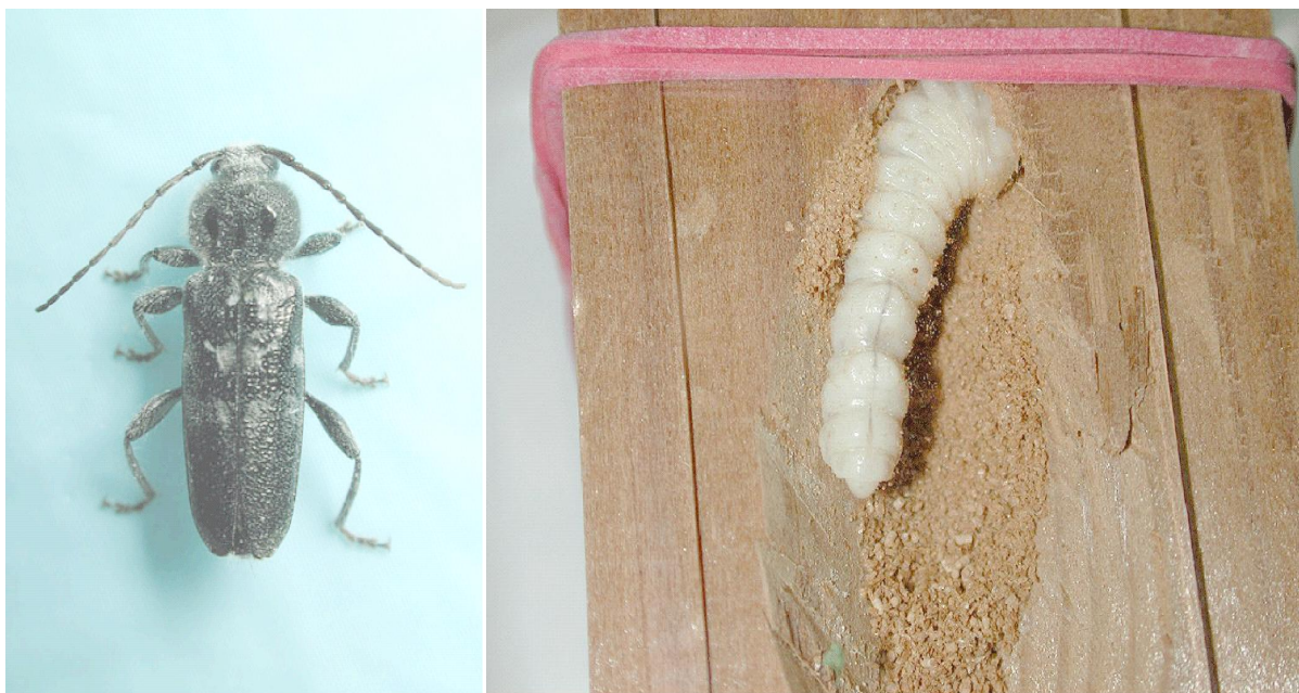
Έντομο Longhorn και προνύμφη σε δοκιμές με ThermoWood. (Jarmo Holopainen, Πανεπιστήμιο του Kuorio)
