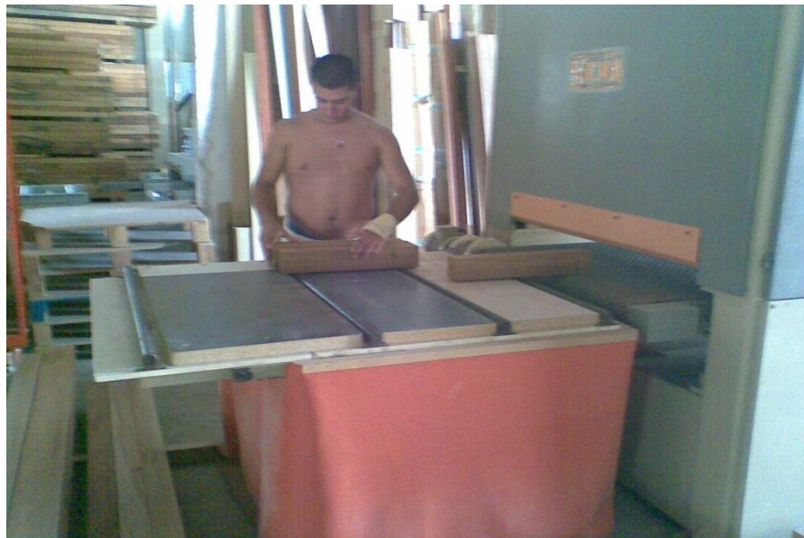
Εικ. 10 Έξοδος των ξυλοτεμαχιδίων από το τριβείο
