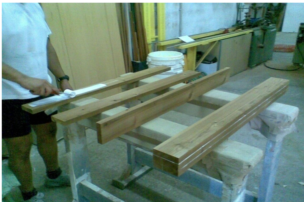
Εικ. 6 Επάλειψη κόλλας πριν το πρεσάρισμα
