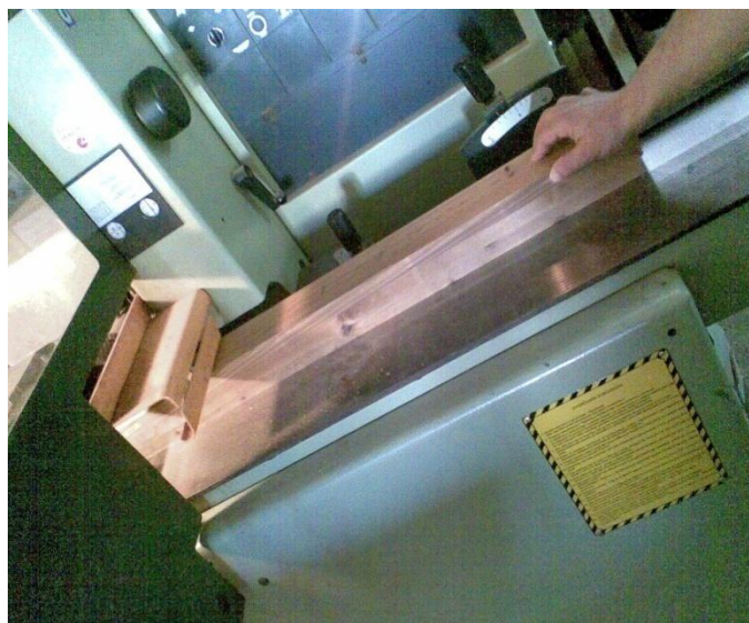
Εικ. 8 Πλανιά – γωνιά στην ραμποτέζα
