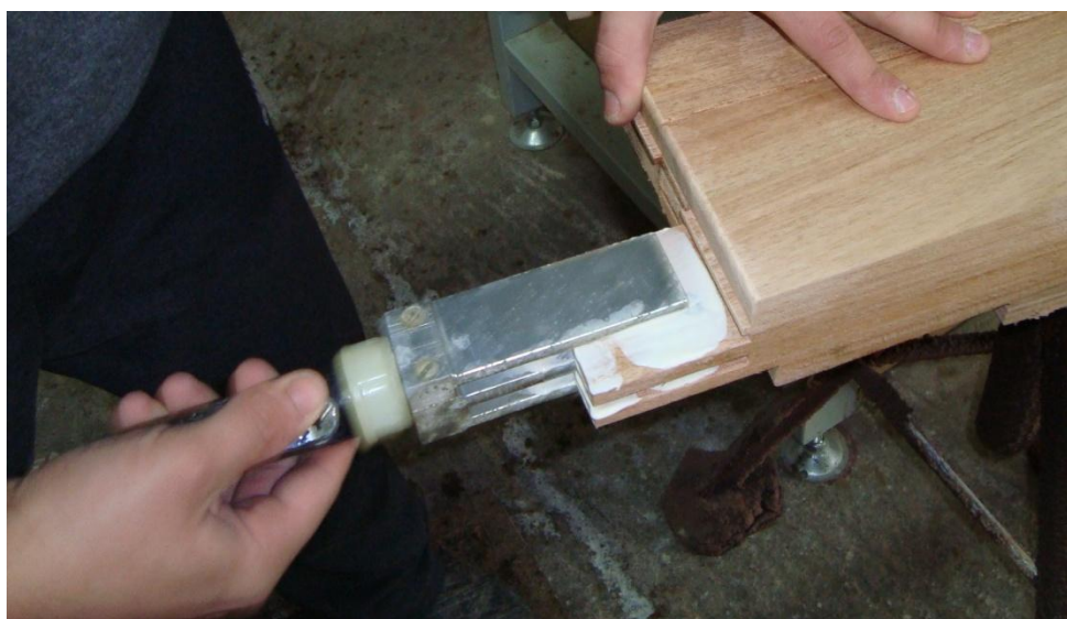
Εικ. 14 Επάλειψη κόλλας με μηχανήμα αέρος
