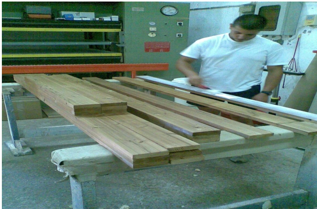
Εικ. 5 Επάλειψη κόλλας πριν το πρεσάρισμα
