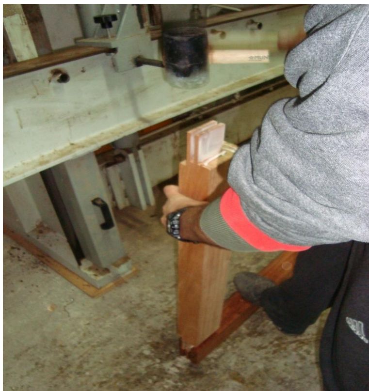
Εικ. 15 Τοποθέτηση τραβέρσας στο μπόι
