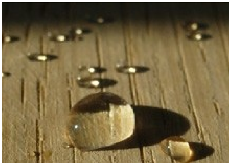
Εικόνα 2.3. Τροποποιημένη με νανοσωματίδια ξύλινη επιφάνεια
