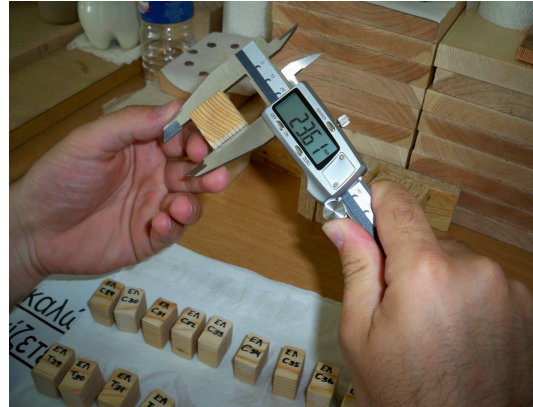
Εικόνα 4.4. Μέτρηση των δειγμάτων με ψηφιακό παχύμετρο
