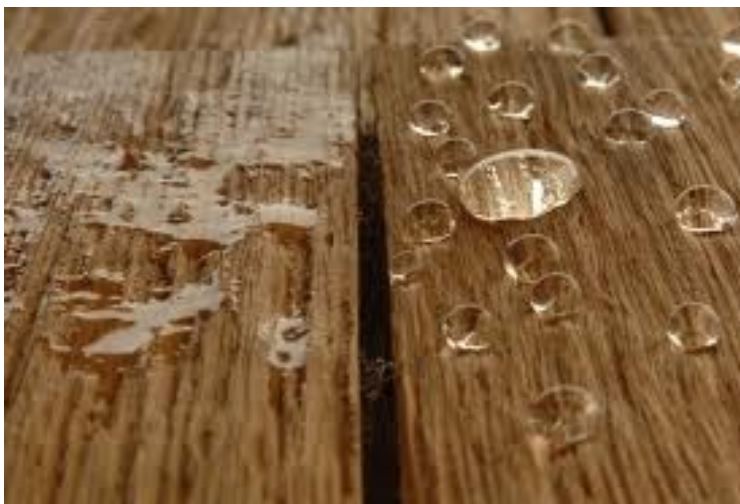
Εικόνα 2.13. Ξύλινη επιφάνεια τροποποιημένη με νανοσωματίδια (δεξιά).
