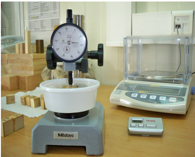
Εικόνα 3.5. Caliper - αυτόματο παχύμετρο ακριβείας.
