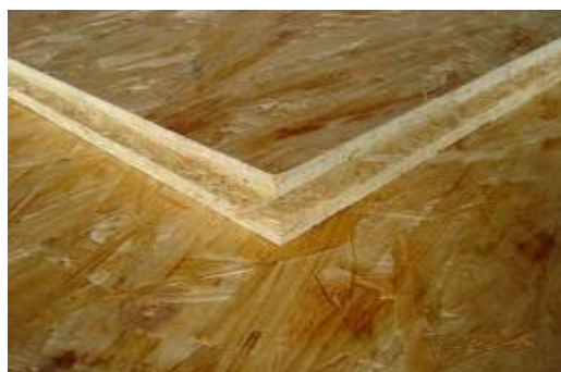
Εικόνα 2.14. Ξυλοπλάκες OSB και μοριοσανίδες
