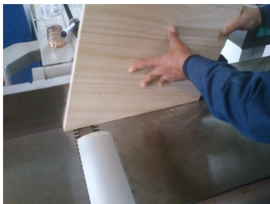
Εικόνα 14.10: Δημιουργία λείας επιφάνειας στην πλάνη.
