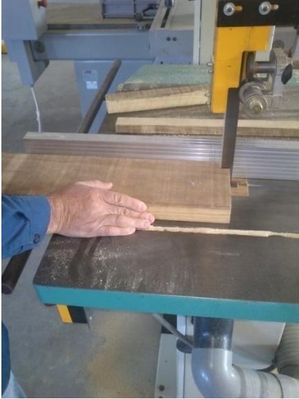
Εικόνα 14.2: Δημιουργία αρχικών τεμαχίων στην πριονοκορδέλα.
