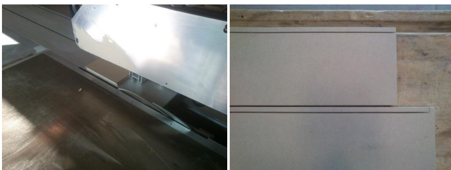
Εικόνα 18.2: Δημιουργία φάλτσου στη γωνιάστρα και γκινισιάς.
