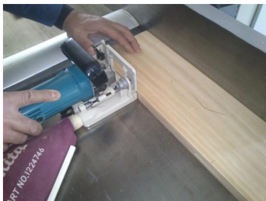
Εικόνα 14.5: Δημιουργία συνδέσεων λαμέλου επιμέρους τεμαχίων.
