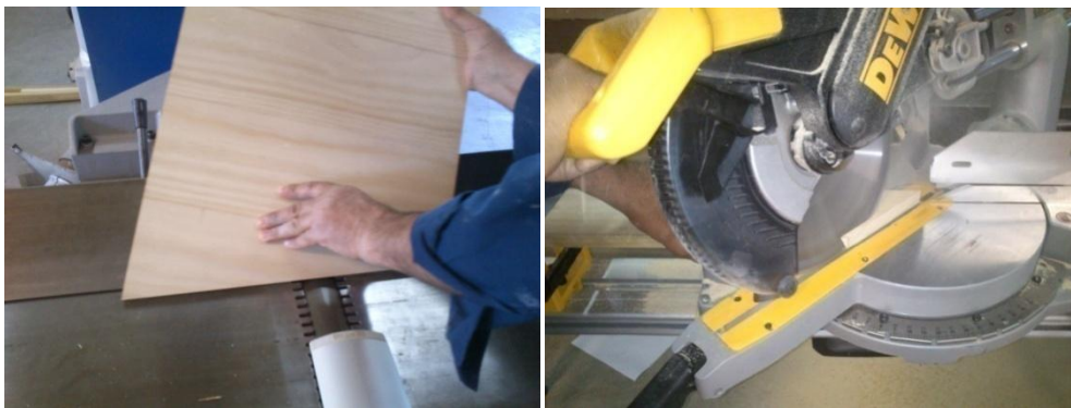
Εικόνα 14.11: Δημιουργία φάλτσου σε πλάνη και φαλτσοκόφτη.
