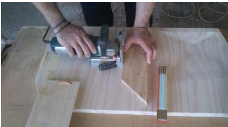
Εικόνα 14.13: Δημιουργία λαμέλου στο πίσο μέρος της σκάφης.
