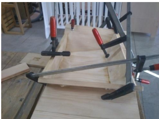
Εικόνα 14.16: Σύνδεση τεμαχίων νιπτήρα αρ.3
