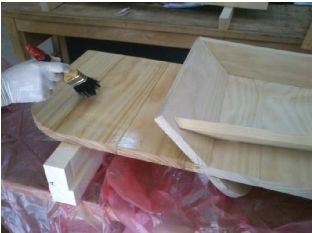
Εικόνα 15.1: Επίστρωση CETOL WF 771.
