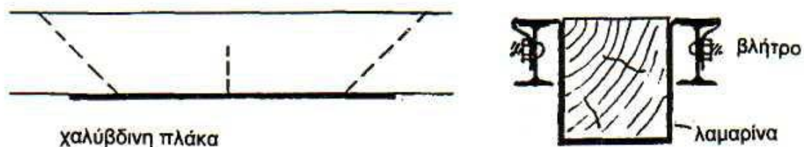
Σχήμα 6. Ενίσχυση ξύλινου δομικού στοιχείου.
