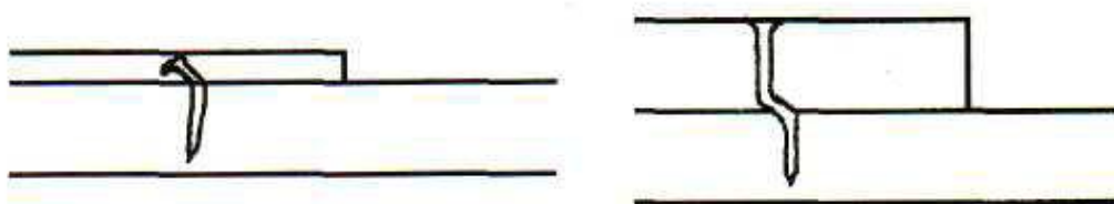
Σχήμα 5. Αστοχία ηλώσεως λόγω κάμψης.
