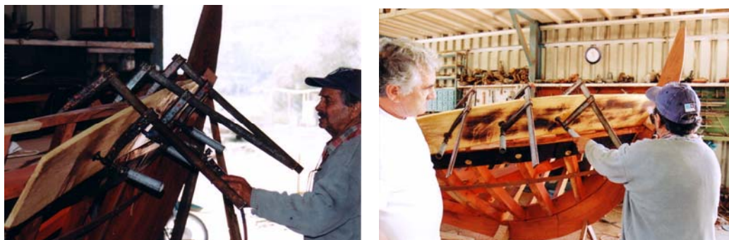
Εικ. 8.21 Χρήση νερού και ζέσταμα με καμινέτο για να λυγίσει το σανίδι και να πάρει την επιθυμητή μορφή.
