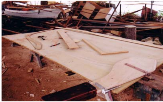
Εικ. 8.5 Σχεδιασμός με τη μέθοδο της σάλας.
