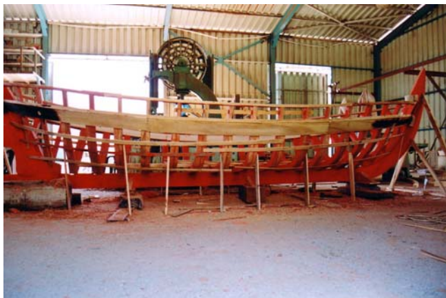
Εικ. 8.19 Χτίσιμο σκάφους. Έχει κατασκευαστεί ο σκελετός και τοποθετείται το πέτσωμα.
