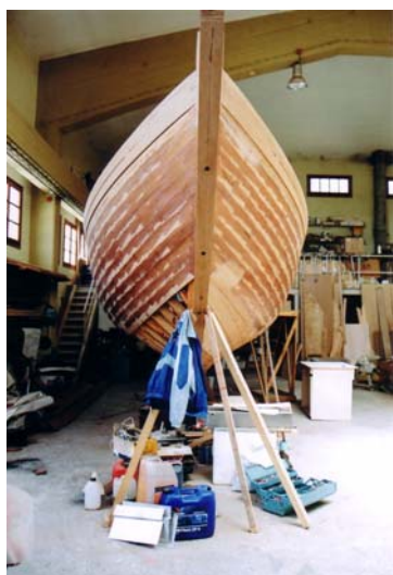
Εικ. 8.31 Σκάφος τύπου Wondered 33 , είναι του 1963 και έχει περάσει 5 φορές τον Ατλαντικό ωκεανό. Είναι το 37 ο σκάφος που χτίζεται ανά τον κόσμο. Κατασκευάζεται με εποξεικές ρητίνες.
