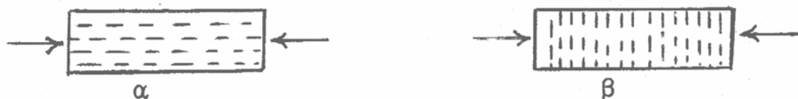
ΣΧΗΜΑ 12. Δοκίμιο ξύλου σε αξονική θλίψη (α) και εγκάρσια θλίψη (β).
