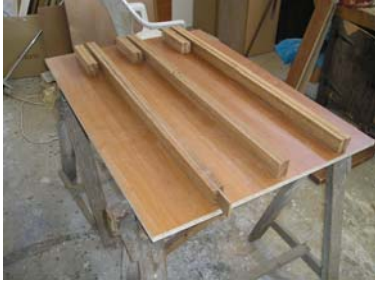
Εικόνα 17: Τεμαχισμένες λωρίδες ξύλου, έτοιμες για συγκόλληση
