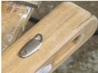
Εικόνα 79: Τοποθέτηση οδηγού σχοινιού (ii)
