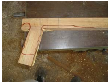
Εικόνα 19: Δημιουργία χειρολαβής με κλίση 15^\circ σε σχέση με τον κορμό
