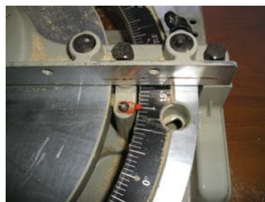
Εικόνα 21: Σχηματισμός γωνίας 15^\circ στο δισκοπρίονο
