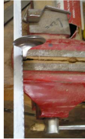
Εικόνα 64: Κόψιμο πάνω μέρος κουταλιού με πριόνι χειρός για μέταλλα
