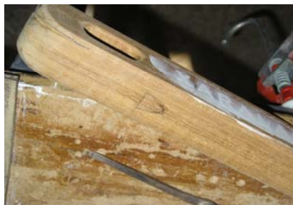
Εικόνα 58: Τοποθέτηση λευκού στόκου
