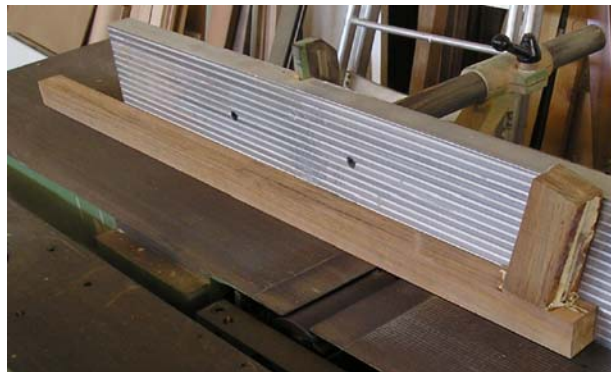
Εικόνα 28: Πλανιάρισμα πάνω επιφάνειας κορμού
