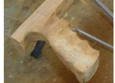
Εικόνα 39: Μορφοποιημένη χειρολαβή μετά τη χρήση ράσπας
