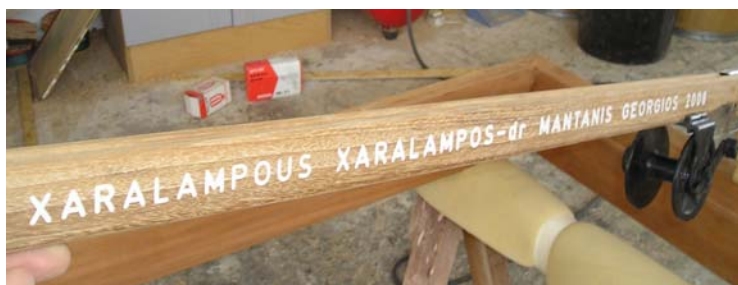
Εικόνα 60: Γράμματα μετά την τοποθέτηση στόκου και λείανση
