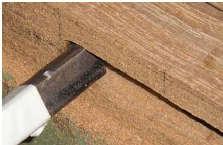
Εικόνα 46: Άνοιγμα οπής με τη βοήθεια οριζόντιου τραπάνου
