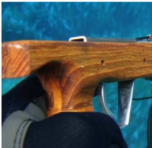
Εικόνα 23: Συνδεσμολογία χειρολαβής με σύνδεση περαστού μάρσου
