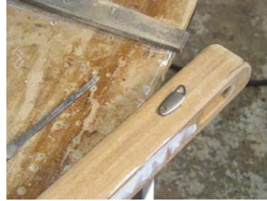
Εικόνα 78: Τοποθέτηση οδηγού σχοινιού (i)
