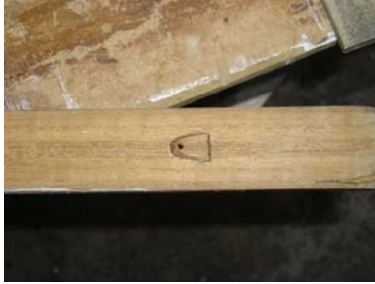
Εικόνα 77: Σχεδιασμός οπής τοποθέτησης οδηγού σχοινιού
