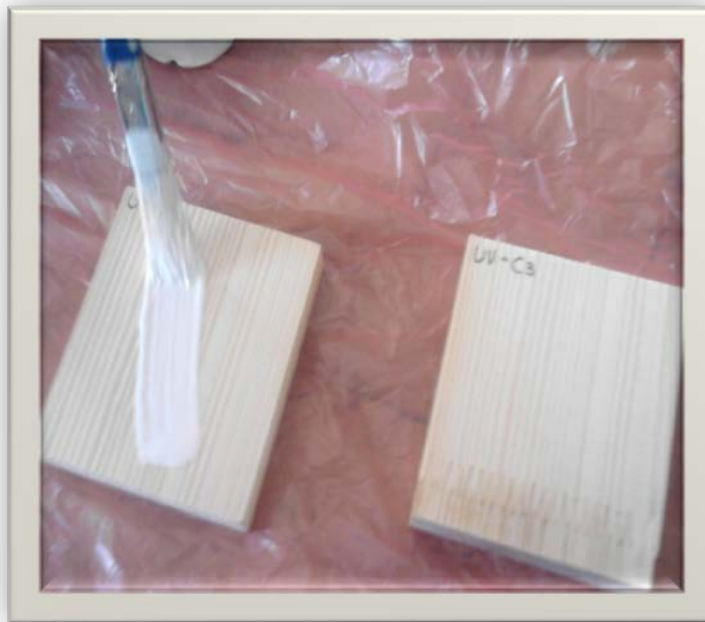
Εικόνα 19 : Επάλειψη πουλυουρεθανικού βερνικιού λευκού χρώματος.
