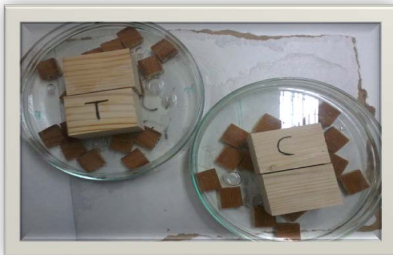
Εικόνα 8 : Παραμονή δειγμάτων σε νερό .
