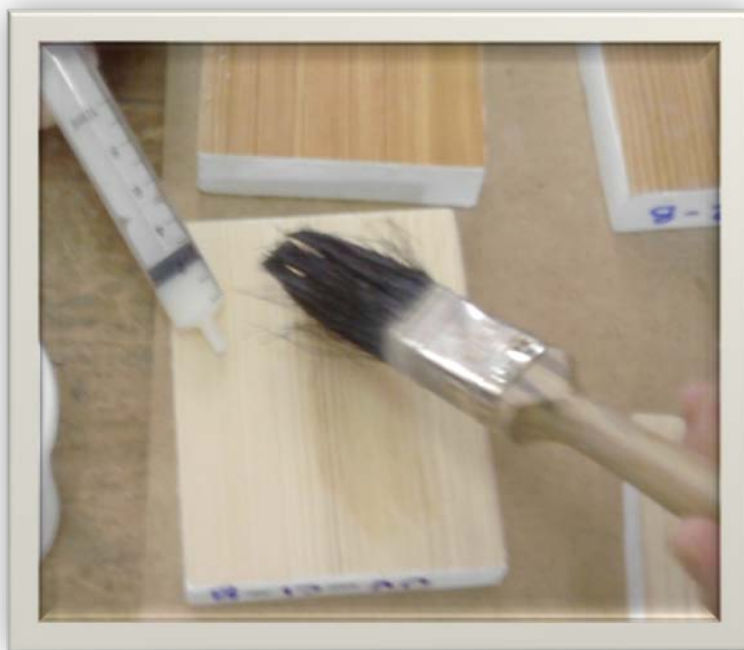
Εικόνα 18 : Επάλειψη με άχρωμο βερνίκι
