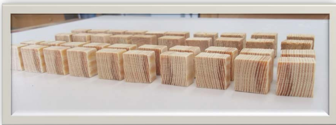
Εικόνα 2 : Δείγματα φαινομενικής πυκνότητας .
