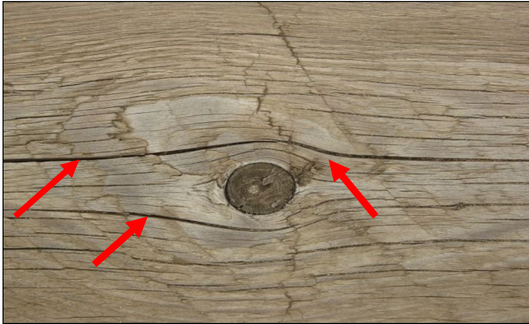
ΕΙΚ. 36. Δημιουργία ραγάδων σε πριστό εξαιτίας της παρουσίας ξηρού ρόζου (σημ.: ο ρόζος δημιουργεί και την απόκλιση από την ευθυΐνια).
